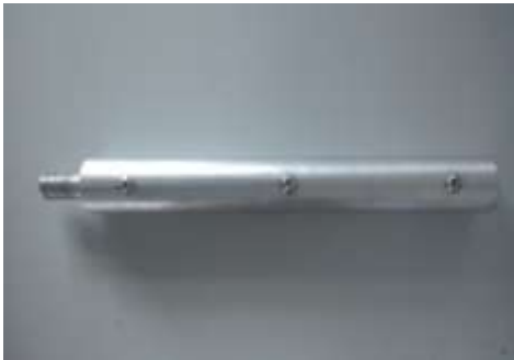
Fig 3.1 Aluminium pin fin
