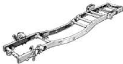
Fig: 2. Ladder type frame
